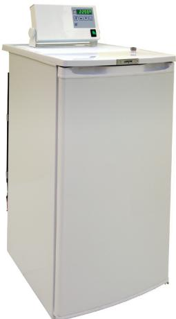
Термостат **БИОТЕСТ** предназначен для определения биохимического потребления кислорода (БПК) и других лабораторных применений. Соответствует требованиям ISO 5815.
