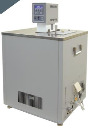
Специализированный криостат **КРИО-ВТ-13** предназначен для поддержания заданной температуры жидкого теплоносителя, циркулирующего во внутренней ванне криостата и в подключенных внешних потребителях. В качестве внешних потребителей к криостату могут быть подключены термостатирующие контуры лабораторных химических реакторов, измерительных приборов и другого оборудования. Криостат КРИО-ВТ-13 предназначен для непрерывной работы.
