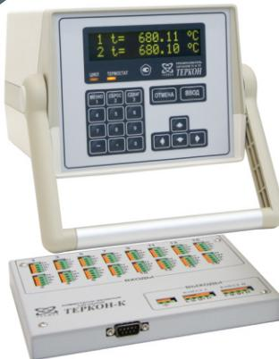
Прецизионный преобразователь сигналов термометров сопротивления и термопар **ТЕРКОН** предназначен для одновременного и независимого измерения сигналов термометров сопротивления или термопар и пересчета измеренных величин сопротивления или напряжения в значения температуры. На входы преобразователя ТС и ТП могут быть одновременно подключены либо два термометра сопротивления, либо две термопары, либо к входу одного канала - термометр сопротивления, а к другому - термопара.
