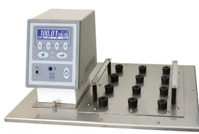
Термостат укомплектован крышкой (держателем) на 12 рабочих мест и резиновыми вкладышами с внутренними отверстиями на 6, 9 и 13 мм (по 4 шт. на каждый диаметр) для установки датчиков температуры.
