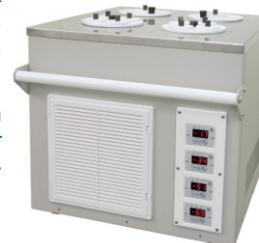
Жидкостные криостаты **КРИО-ВТ-05-01** и **КРИО-ВТ-05-04** предназначены для поддержания заданной температуры при определении низкотемпературных характеристик нефтепродуктов в соответствии с ГОСТ 20287, ГОСТ 5066, ГОСТ 22254, ГОСТ 18995.5, ASTM D97 (ISO 3016), ASTM D7346, ASTM D2386 (ISO 3013), ASTM D2500 и ASTM D6371.
