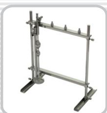
Штатив для вискозиметров позволяет удобно разместить до шести подготовленных к измерению вискозиметров любого вида
