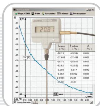
Имея небольшую постоянную времени, великолепное разрешение и точность измерения температуры, ЛТ-300 вкупе с программой **ThermoChart** является хорошим средством для создания систем измерения температуры, например, калориметрических установок.
