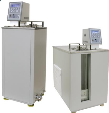
Жидкостные термостаты и криостаты модельного ряда **BT-ро** предназначены для поддержания заданной температуры при проведении измерений плотности нефтепродуктов в соответствии с ГОСТ 3900, ГОСТ Р51069, ASTM D1298, IP 160 и ISO 3675. Все термостаты и криостаты этого модельного ряда снабжены приспособлением для установки шести стеклянных или металлических цилиндров для ареометров.
