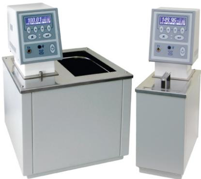
Термостаты модельного ряда **ВТ** предназначены для поддержания заданной температуры жидкого теплоносителя, циркулирующего во внутренней ванне термостата и в подключенных внешних потребителях. В качестве внешних потребителей к термостатам могут быть подключены термостатирующие контуры лабораторных химических реакторов, измерительных приборов и другого оборудования.
