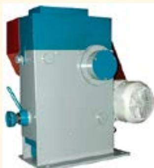
Предназначена для переработки горных пород, керамики, огнеупоров, строительных материалов.
