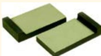
Предназначены для передачи нагрузки на половинки образцов-балочек согласно ГОСТ 310.4.
