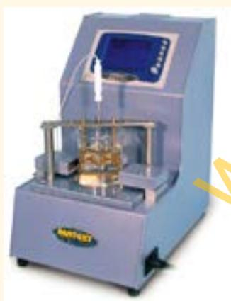
Используется для определения точки размягчения битумных материалов методом «Кольца и шара».
