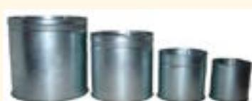
Мерные цилиндрические сосуды КП-601/4 предназначены для испытания щебня при определении насыпной плотности и пустотности по ГОСТ 8269.
