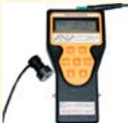
Предназначен для контроля амплитуды и частоты синусоидальных колебаний виброустановок, применяемых для уплотнения бетонных смесей при производстве железобетонных изделий, а также для измерения параметров вибрации других объектов.
