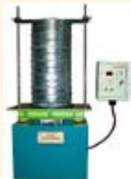
Предназначен для определения зернового состава щебня (гравия) нефракционного и данной фракции по ГОСТ 8269-76.
