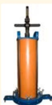
Плотномер водобаллонного типа, предназначенный для определения плотности грунтов методом замещения объёма по ГОСТ 28514-90 в полевых условиях.
