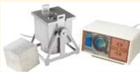
Измеритель морозостойкости бетона дилатометрический предназначен для определения морозостойкости тяжелых и легких бетонов на цементном вяжущем ускоренным дилатометрическим методом по ГОСТ 10060.3 при однократном замораживании образцов-кубов или кернов.
