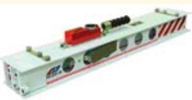
Предназначена для измерения поперечных и продольных уклонов дорожных покрытий и обочин, неровностей оснований и покрытий автомобильных дорог и аэродромов, определения крутизны заложения откосов, насыпей и выемок.
