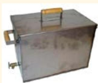
Бачок предназначен для проведения испытаний цемента на равномерность изменения объёма по ГОСТ 310.3-78.
