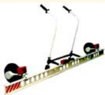
Предназначено для контроля ровности, определения радиусов кривых в плане, измерения поперечных и продольных уклонов дорожных оснований и покрытий, обочин и поверхностей земляного полотна, насыпей и выемок для определения коэффициента заложения откосов земляного полотна.
