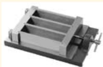
Предназначены для изготовления лабораторных контрольных образцов размером 40x40x160 мм, служащих для определения физико-механических характеристик цемента.
