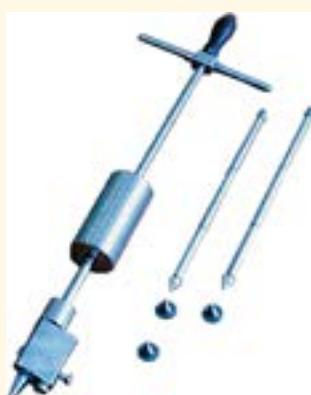
Динамический плотномер предназначен для контроля качества уплотнения земляного полотна, песчаных и мелкозернистых асфальтобетонных покрытий.
