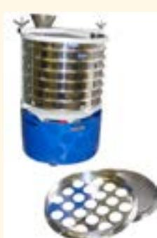
Состоит из виброприводом с устройством крепления, набора сит, крышки, поддона. Подлежащий рассеву материал засыпается в верхнее сите, после чего пакет сит, поддон кольцом и крышка фиксируются на приводе с помощью устройства крепления. Тип вибропривода, количество установленных и дополнительных сит и промежуточных колец и т.д. определяются по Вашим требованиям.
