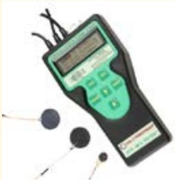
Предназначены для измерения плотности тепловых потоков, проходящих через однослойные и многослойные ограждающие конструкции зданий и сооружений через облицовку и теплоизоляцию энергообъектов при экспериментальном исследовании и в условиях эксплуатации. Приборы позволяют измерять температуру воздуха внутри и снаружи помещения, а также определять сопротивление теплопередаче и термическое сопротивление ограждающих конструкций и изделий.
