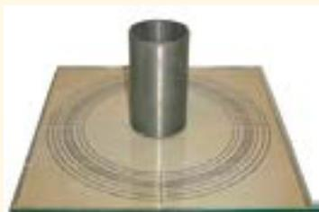
Предназначен для определения стандартной консистенции (нормальной густоты) гипсового теста, которая характеризуется диаметром расплыва, вытекающего из цилиндра при его поднятии. Диаметр расплыва по ГОСТ 23789-79 должен быть равен (180±5) мм.
