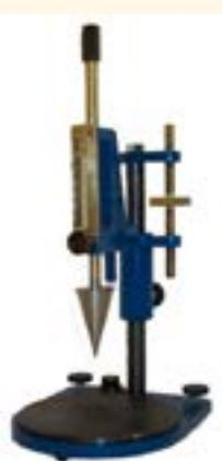
Предназначен для определения пределов пластичности и консистенции глинистых грунтов методом конуса.
