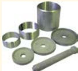
Комплект колец предназначен для отбора образцов грунта при определении плотности в соответствии с ГОСТ 5180-84
