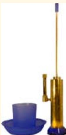
Предназначен для определения коэффициента фильтрации песчаных грунтов, применяемых в дорожном и аэродромном строительстве при устройстве дренирующих и морозоустойчивых слоев дорожной и аэродромной одежды в соответствии с ГОСТ 25584-90 (приложение 5) с изменениями №1 от 02.12.93.
