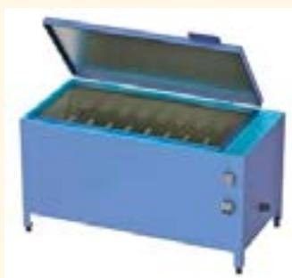
Предназначен для определения прочности цемента при пропаривании по ГОСТ 310.4.
