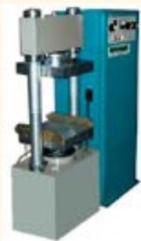
Гидравлическая машина с электрическим силоизмерением для статических испытаний на сжатие стандартных образцов бетонов, кирпича и других строительных материалов с наибольшей предельной нагрузкой 100 кН, 500 кН, 1000 кН, 2000 кН (соответственно модели).
