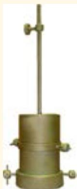
Предназначен для определения максимальной плотности и оптимальной влажности грунта по ГОСТ 22733-02.
