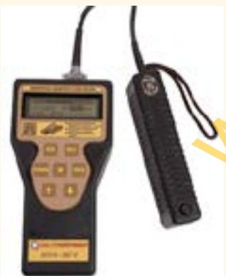
Предназначены для оперативного контроля толщины защитного слоя бетона и расположения стержневой арматуры в железобетонных изделиях и конструкциях магнитным методом.
