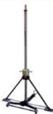
Предназначен для измерения коэффициента сцепления дорожных покрытий при строительстве и ремонте автомобильных дорог, периодическом и текущем контроле состояния дорожных покрытий.
