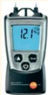
Игольчатый влагомер Testo 606-1 предназначен для измерения влажности древесины, бетона и других строительных материалов. Позволяет проводить измерения влажности на поверхности и небольшой глубине (до 2 см), идеален для контроля тонких строительных материалов.
