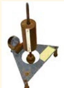
Предназначен для определения твердости дорожного покрытия на всех типах дорог, устроенных с использованием органических вяжущих в соответствии с ВСН38-90.
