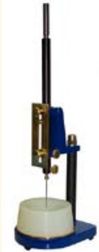
Прибор Вика ОГЦ-1 предназначен для определения нормальной густоты и сроков схватывания цементного теста по ГОСТ 310.3-76.
