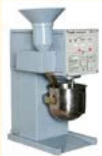
Смеситель предназначен для приготовления цементного раствора, используемого при изготовлении цементных образцов-балочек. Смеситель работает в автоматическом режиме, включая дозированную засыпку песка. По окончании цикла приготовления раствора смеситель автоматически выключается.
