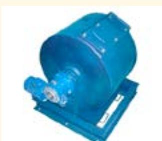
Предназначен для проведения лабораторных испытаний по определению истираемости щебня по ГОСТ 8269.0-97.
