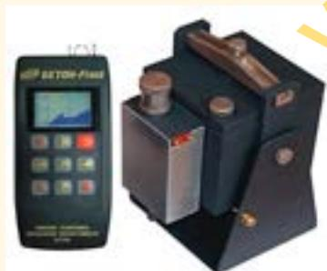
Обеспечивает ускоренное определение морозостойкости бетона дилатометрическим методом при однократном замораживании водонасыщенных образцов-кубов по ГОСТ 10180, кернов по ГОСТ 28570 и цементных кубиков.
