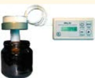
Предназначен для определения активности портландцемента, портландцемента с минеральными добавками, шлакопортландцемента. Применяется в заводских и научно-исследовательских лабораториях при проведении экспресс-исследований свойств минеральных вяжущих веществ.
