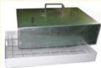
Ванна с гидроатватором ВГЗ предназначена для хранения образцов во влажных условиях в соответствии с ГОСТ 310.3-76.
