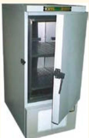
Камера применяется для испытания бетонных образцов по ГОСТ «Базовый и ускоренный метод определения морозостойкости бетона способом многократного замораживания и оттаивания».
