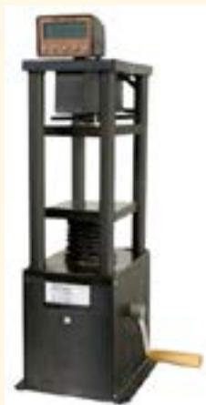
Предназначены для испытаний образцов из пенополистирола, пенопластов, минераловатных плит и других теплоизоляционных материалов на сжатие при 10 % линейной деформации и на изгиб.
