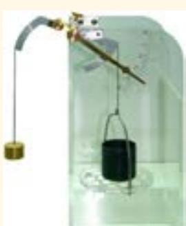
Предназначен для получения лабораторных данных скорости и характера размокания грунтов (распада образца грунта под воздействием воды без нормирования точности по РСН 51-84 (приложение 8) с ненарушенной структурой при естественной влажности и с нарушенной структурой).
