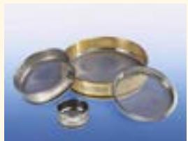
Предназначены для испытания щебня и гравия по ГОСТ 8269.0-97.
